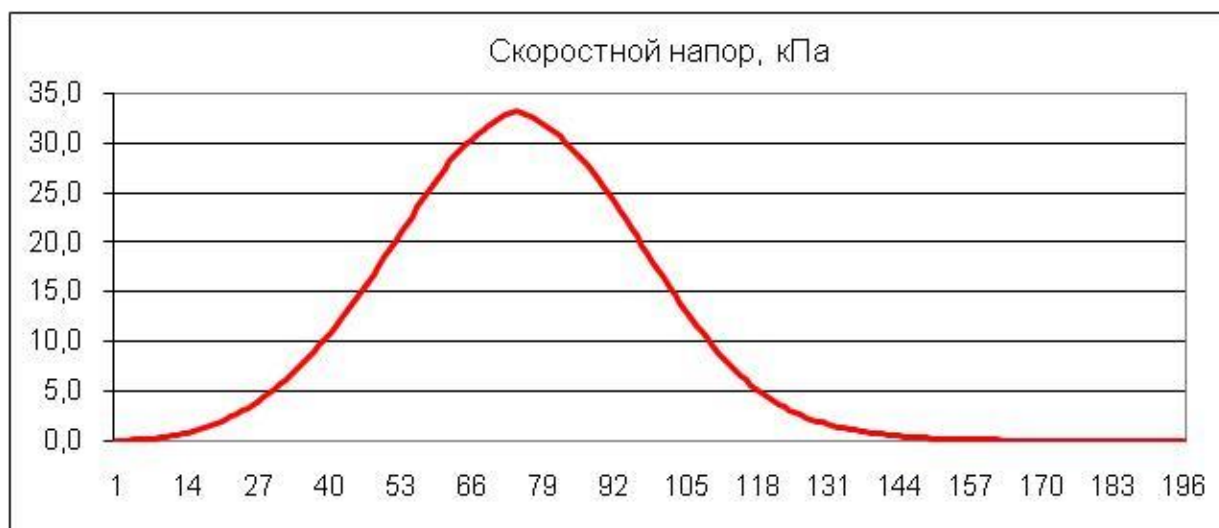
Рисунок 22 - График скоростного напора (ось Y, кПа) от времени (ось X, сек)
