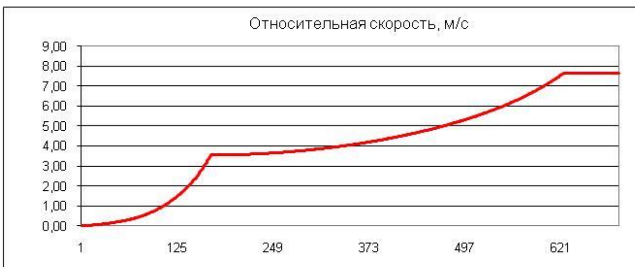
Рисунок 20 - График относительной скорости (ось Y, км/с) от времени (ось X, сек)
