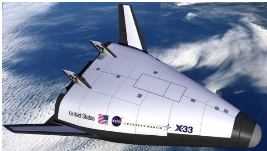
Рисунок 41 - Предполагаемый внешний вид РН вертикального взлета и горизонтальной посадки X-33
