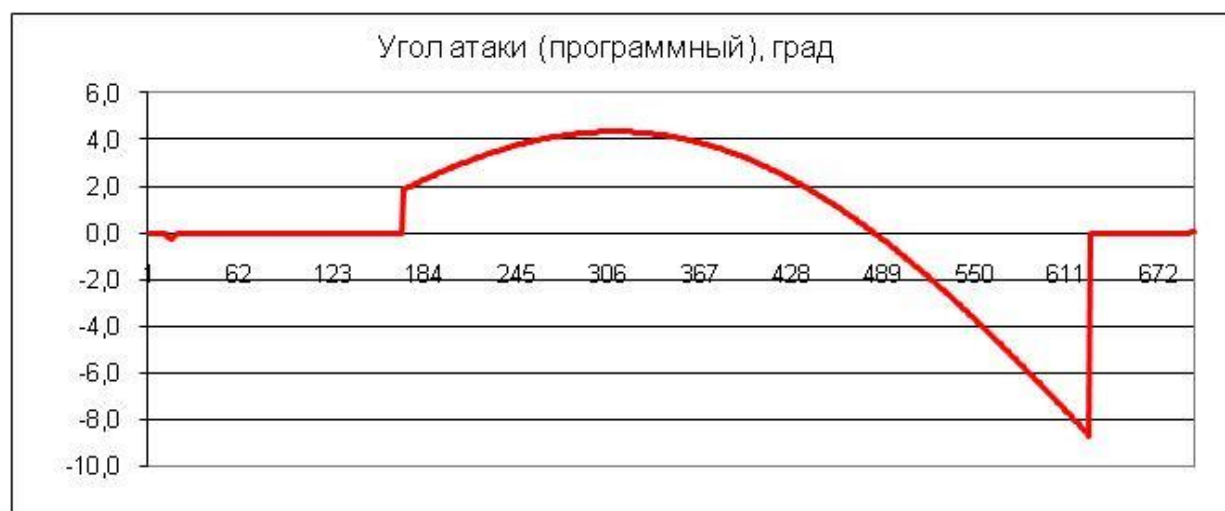
Рисунок 24 - Программный угол атаки (ось Y, град) от времени (ось X, сек)
