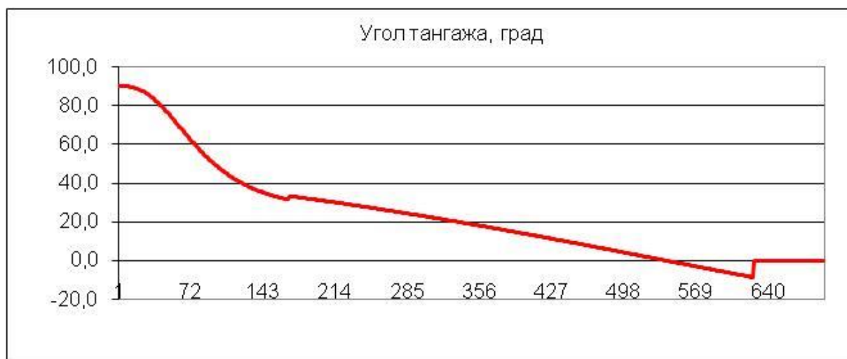
Рисунок 23 - Программный угол тангажа (ось Y, град) от времени (ось X, сек)
