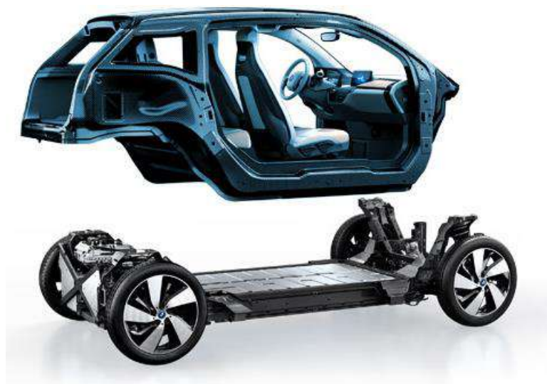
Рисунок 18 – LifeDrive архитектура BMW из алюминиевой платформы с двигателем, подвеской, коробкой передач и аккумуляторными батареями, внешнего кузова из углепластика
