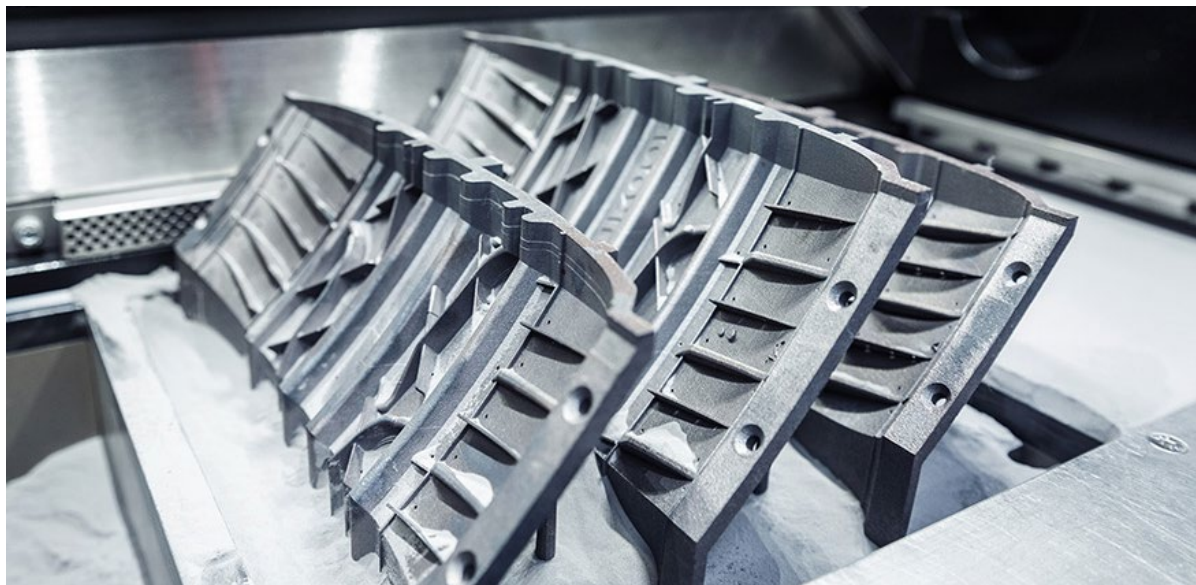
Рисунок 19. Металлическая форма для создания протектора шины компании Hankook
