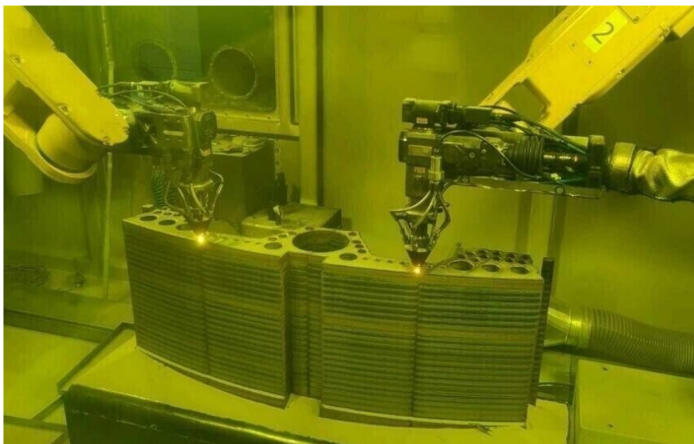
Рисунок 10. 3D-печать фрагмента выгородки внутрикорпусного устройства энергетического ядерного реактора методом прямого лазерного выращивания
