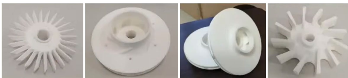
Рисунок 21. Комплектующие и запчасти в компании «СИБУР», сделанные с помощью 3D-печати
