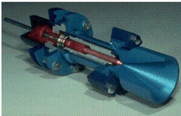
Рисунок А.1 - Внешний вид модели электронагревного двигателя в разрезе
