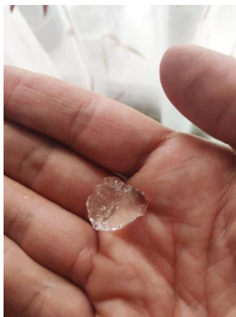
Рисунок 28 - Гранула заправленного водой гидрогеля
