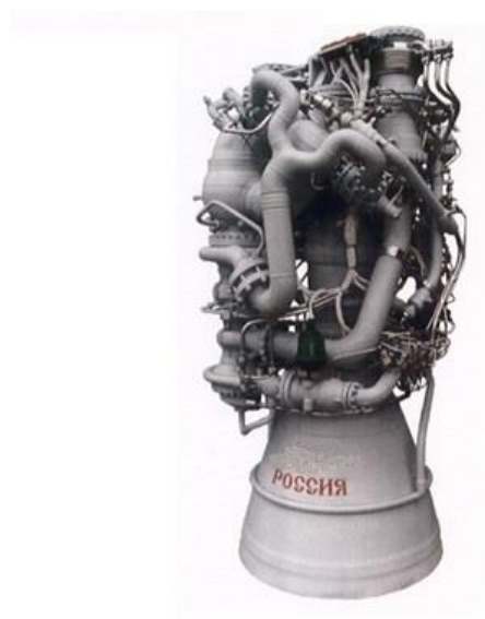
Рис. 49. Двигатель РД-182 для первых ступеней ракет-носителей
