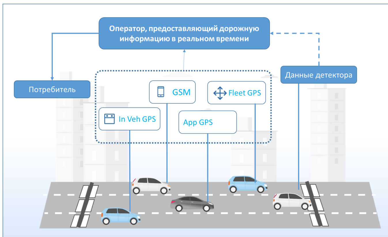
Рис. 5 Процесс сбора и обработки данных датчиков дорожной инфраструктуры и устройств на борту автомобиля в целях реализации сервисов информирования пользователей
