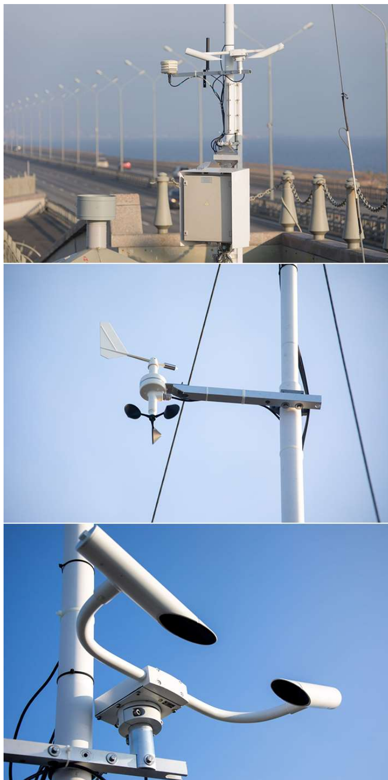
Рисунок 3.7 – Компоненты автоматической дорожной метеостанции [162]
