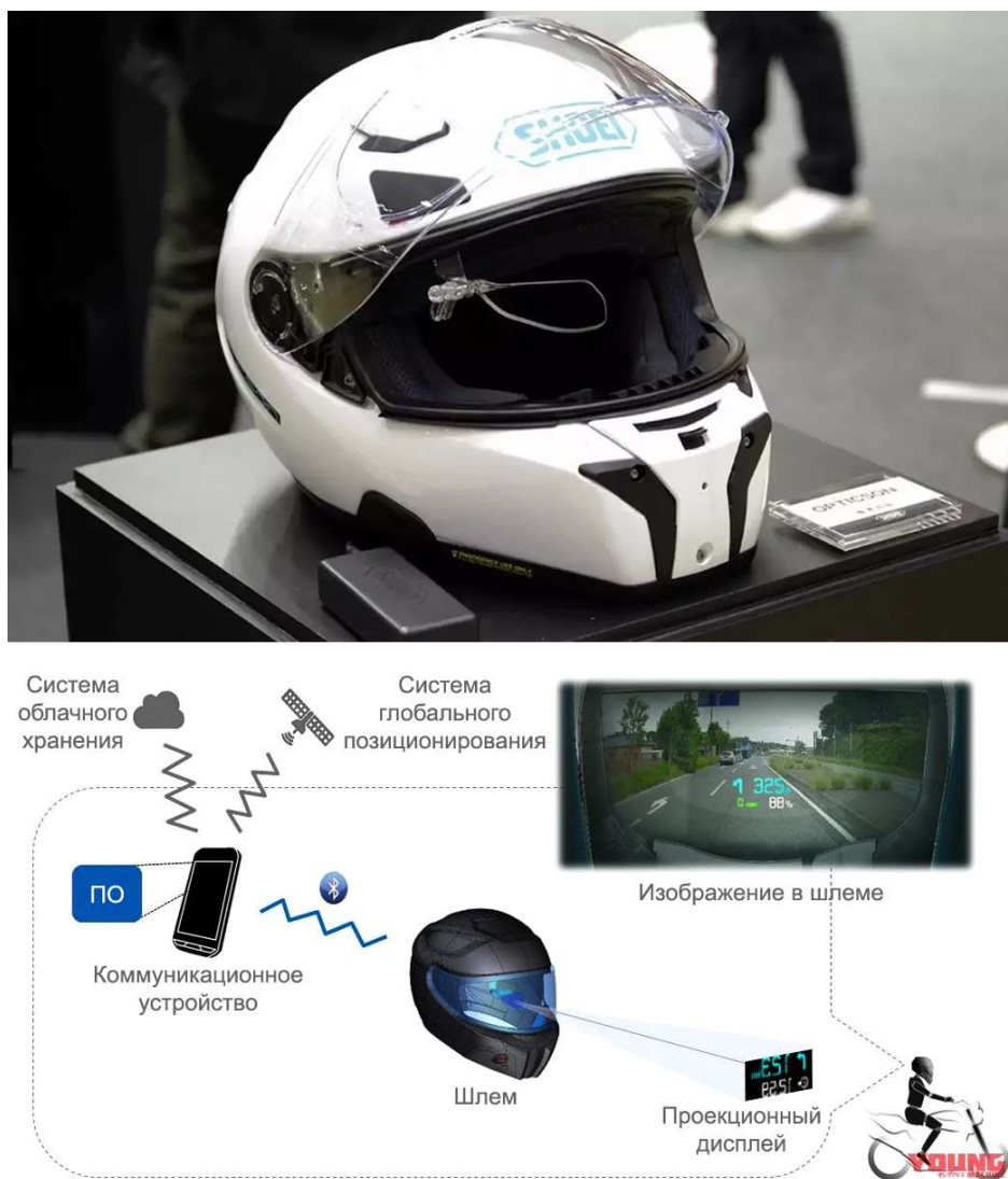
Рисунок 3.6 – Внешний вид и окружающая инфраструктура шлема для мотоциклистов с технологией дополненной реальности [148, 149]
