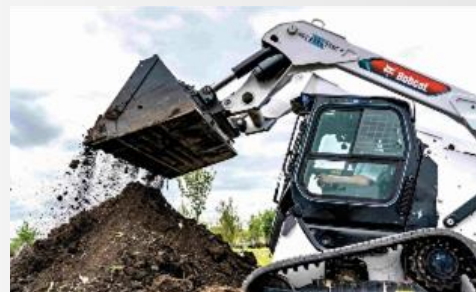
Инновационная автоматическая система встряхивания ковша
