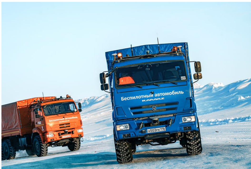
Рисунок 6.16 – Беспилотные грузовики КАМАЗа и ГАЗа на испытаниях для «Газпром нефть»
