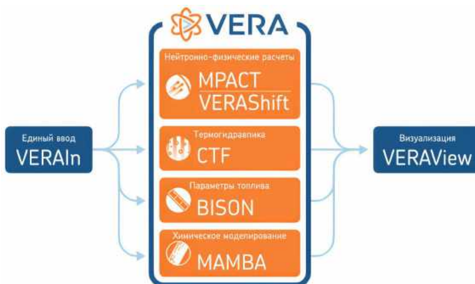
Рисунок 14. Схема моделирования в среде VERA
