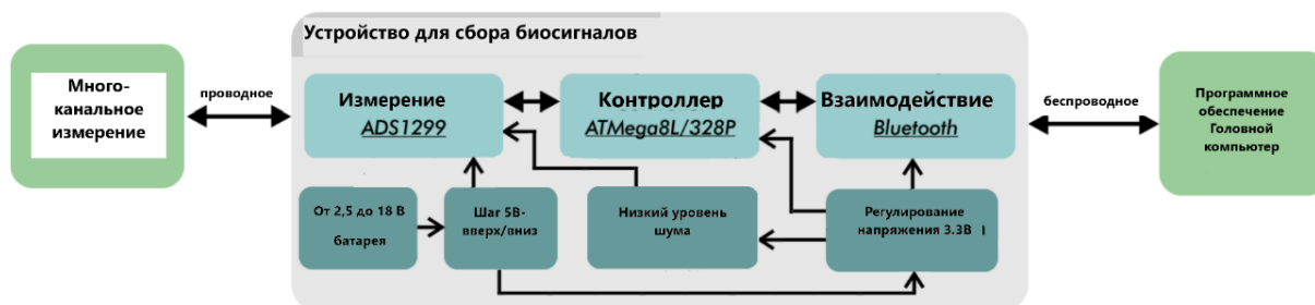
Рисунок 38– Схема устройства для сбора биосигналов ЭЭГ / ЭМГ
