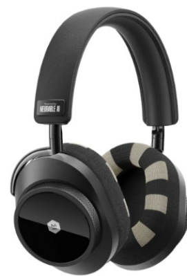
Рисунок 57 - MW75 Neuro «умные» наушники с датчиками ЭЭГ для неинвазивного мониторинга активности мозга
