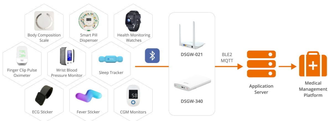
Рисунок 29 – Устройства с поддержкой IoT для решения для удаленного мониторинга пациентов, которые позволяют поставщикам услуг отслеживать, сообщать и анализировать острое или хроническое состояние здоровья своего пациента за пределами больницы или клиники
