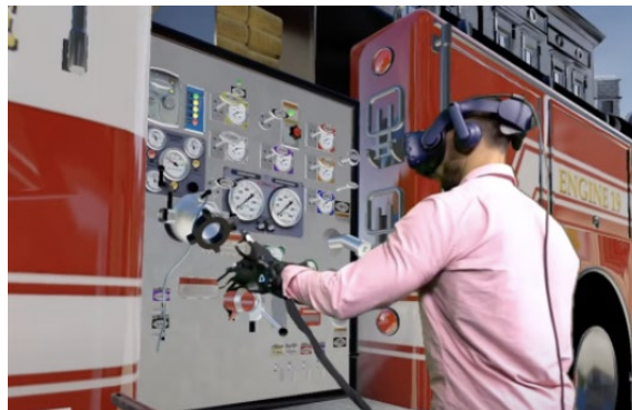
Рисунок 51– Иммерсивная среда от компании HaptX с тактильными перчатками – пожарная машина – для обучения работы на системе подачи воды
