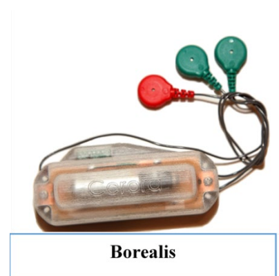
Рисунок 42- Решение Borealis сочетает данные сенсоров ЭЭГ, которые по беспроводной связи передаются в облачную инфраструктуру Cerora, где анализируются с помощью специальных алгоритмов, что позволяет генерировать клинические отчёты примерно за 1 минуту
