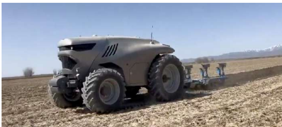
Рисунок 30 – Полностью автономный трактор Honghu T70
