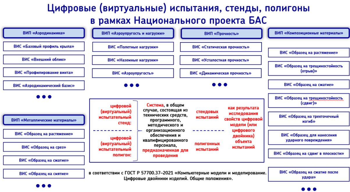
Рисунок 41. Цифровые (виртуальные) испытательные стенды и полигоны для проведения цифровых испытаний беспилотных летательных аппаратов на цифровой платформе CML-Bench®, разрабатываемые в рамках реализации Стратегии развития беспилотной авиации РФ
