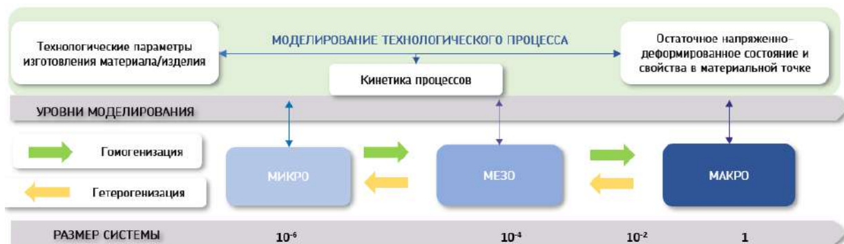
Рисунок 38. Концепция уровней многомасштабного моделирования для КМ
