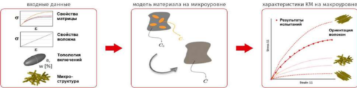
Рисунок 39. Микроуровневый подход для определения характеристик композиционных материалов для программного комплекса Digimat
