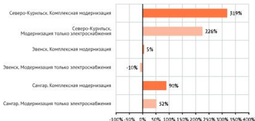
Рисунок 6. Окупаемость инвестиций 1 (%) в проектах модернизации энергоснабжения поселков Сангар, Эвенск и города Северо-Курильск в зависимости от глубины модернизации системы энергоснабжения. Источник: Центр «Энерджинет»
