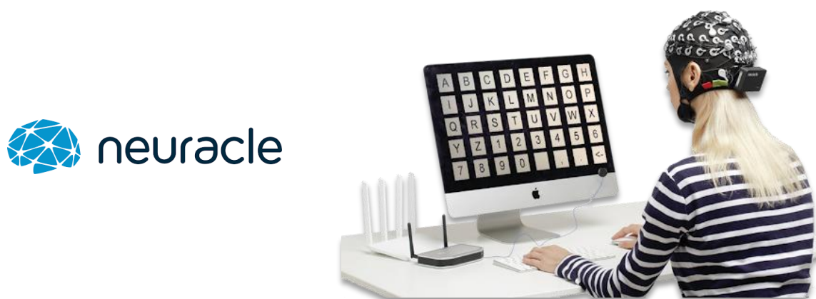
Рисунок 39 - Беспроводная система сбора ЭЭГ серии NeuSen W 29
