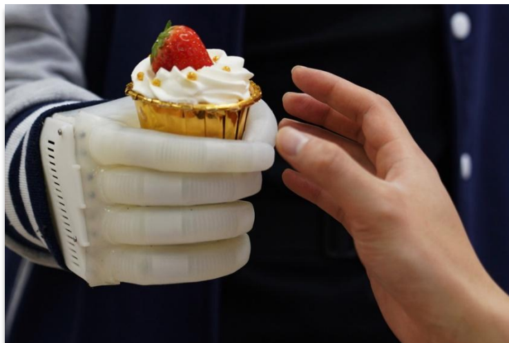
Рисунок 46 - Совместная разработка Массачусетского технологического института и Шанхайского университета Цзяо Тонг - эластичный нейропротез кисти руки 34
