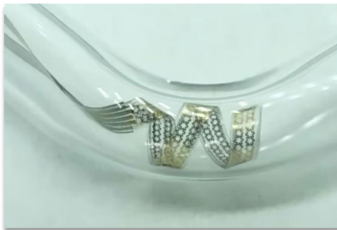
Рисунок 51 - Датчик активности мозга SpiralE Источник изображений: Nature Communications (2023)
