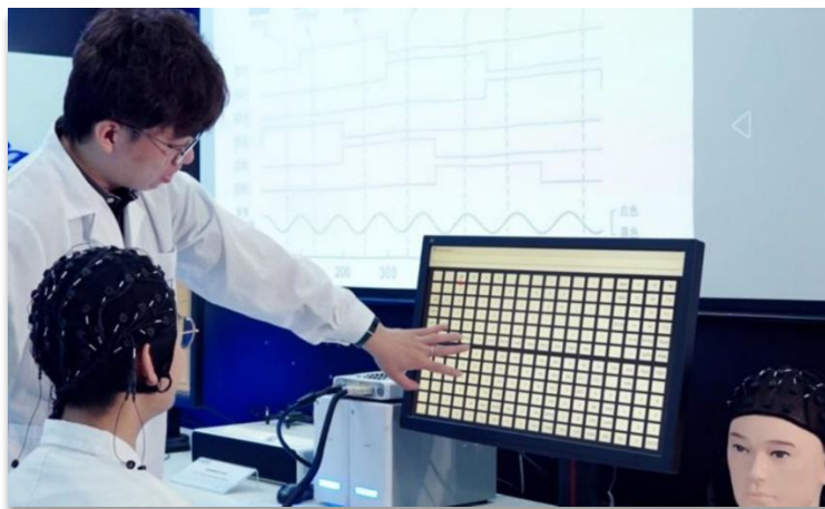
Рисунок 36 - 18 мая 2023 года команда нейробиологов из Тяньцзиньского университета продемонстрировала высокоскоростной интерфейс «мозг-компьютер» (BCI) с 216 целями.
