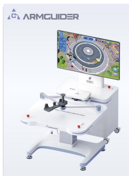
Рисунок 50 - Тренировочная система для реабилитации верхних конечностей ArmGuider® от компании ZD Medtech 38
