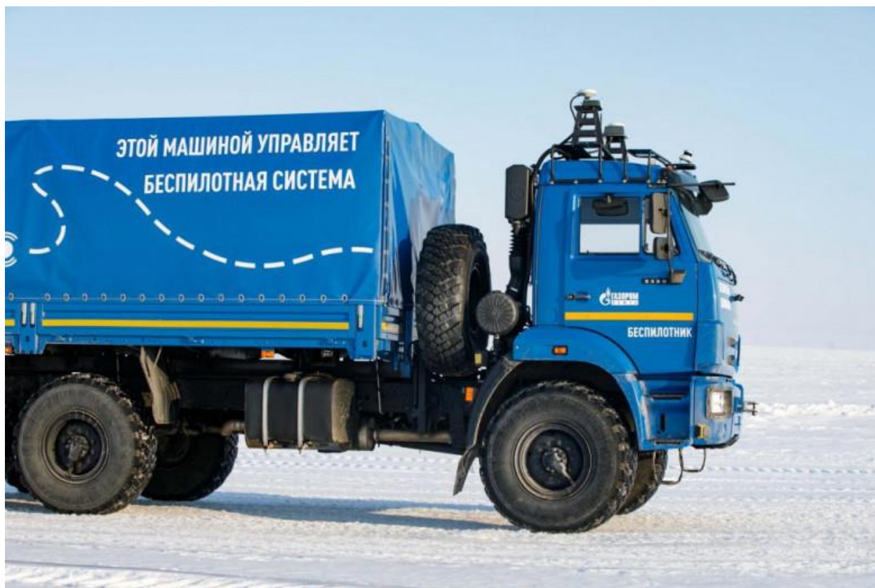
Рисунок 4.4 – Беспилотный грузовик от КАМАЗ, работающий в условиях Крайнего Севера
