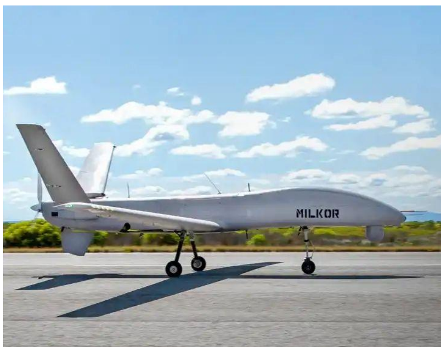
Рис. 11. БВС Milkor с австрийской силовой установкой Rotax 915 iS.
